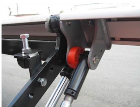
OAM006 - Tope en el brazo debajo del piso de la carrocería
